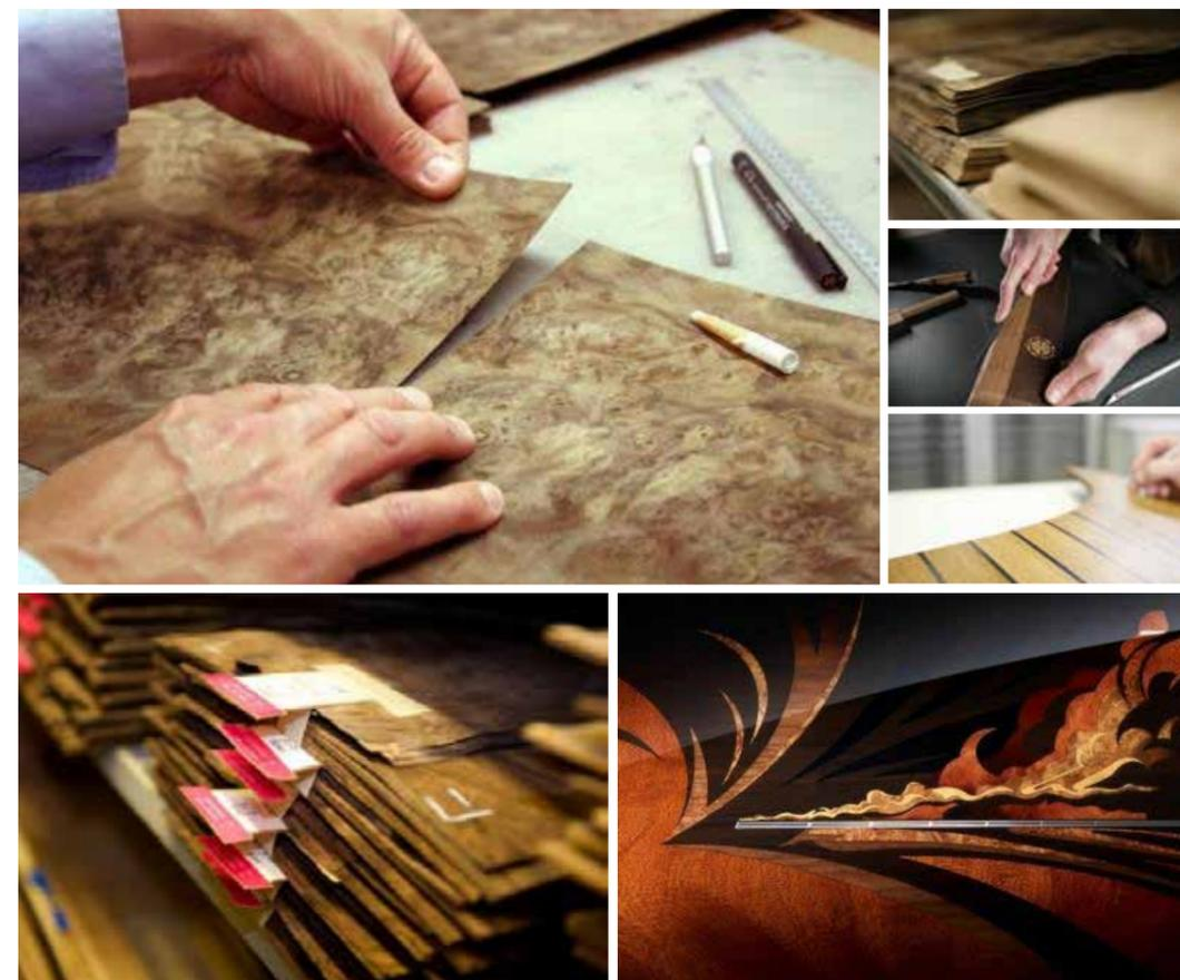
Die Umrandung der Rundinstrumente wird per Hand geschliffen, mit immer feinerem Sandpapier; bis zur Körnung 600. Danach wandern die Finger der Spezialisten über das Holz, es wird perfektioniert, bis keine noch so feine Erhebung mehr spürbar ist. Schaut man den Menschen hier im „Wood Shop“, der Holzabteilung im Rolls-Royce Werk, bei der Arbeit zu, entsteht der Eindruck, sie arbeiten nicht für Rolls-Royce, sondern schaffen ihr eigenes großes Kunstwerk.
