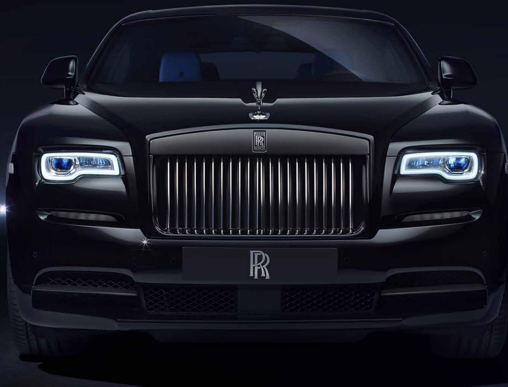
При этом инженеры сделали Ghost Black Badge чуть агрессивнее прототипа, благо возможности 12-клапанного мотора объемом 6,6 литра почти безграничны. С помощью тонкой настройки двигателя мощность автомобиля повысили на 40 л. с. (30 кВт), до 603 л. с. (450 кВт), а крутящий момент — на 60 Нм, до 840 Нм. Восьмиступенчатая автоматическая коробка передач была доработана так, чтобы добиться более интенсивного разгона.
